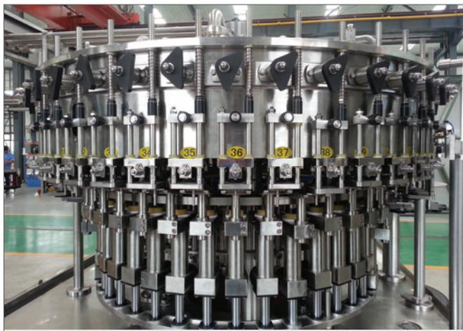
△ 所有灌装筒和阀门（碳酸饮料的重要生产部件和食品接触部件）、泵和管道均由316L型不锈钢制成。
